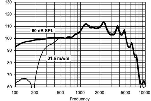
**Datos técnicos** Obtenidos durante un procedimiento de medición estándar con tonos puros. Audífono en Modo de ganancia de test de referencia de Compass. De no ser así, se indicará. Medidos con un codo normal y un acoplador BTE estándar. Para más información, visite [global.widex.com](http://global.widex.com).
