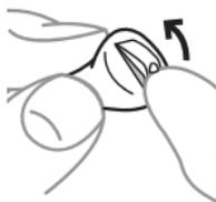
Abra el compartimiento de la batería para apagar el audífono.
