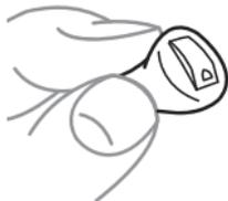
Para encender el audífono, cierre la tapa del compartimiento de la batería. El audífono emitirá una señal de sonido para indicar que está encendido, a menos que su audioprotesista haya desactivado esta función.
