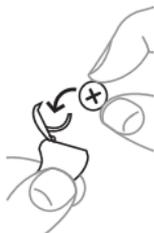
Utilice el ñero para abrir con cuidado el compartimento de pila y retirar la pila agotada.
