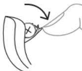
Utilice el uñero para abrir con cuidado el compartimento de pila y retirar la pila agotada.
