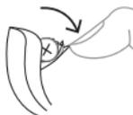
Para apagar el audífono, abra el compartimento de pila hacia abajo.
