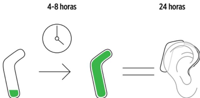
Cuando escuche la alarma de la batería que indica que tiene poca carga, tendrá de 3 a 4 horas de uso normal. El audífono se apagará cuando la batería esté críticamente baja.
